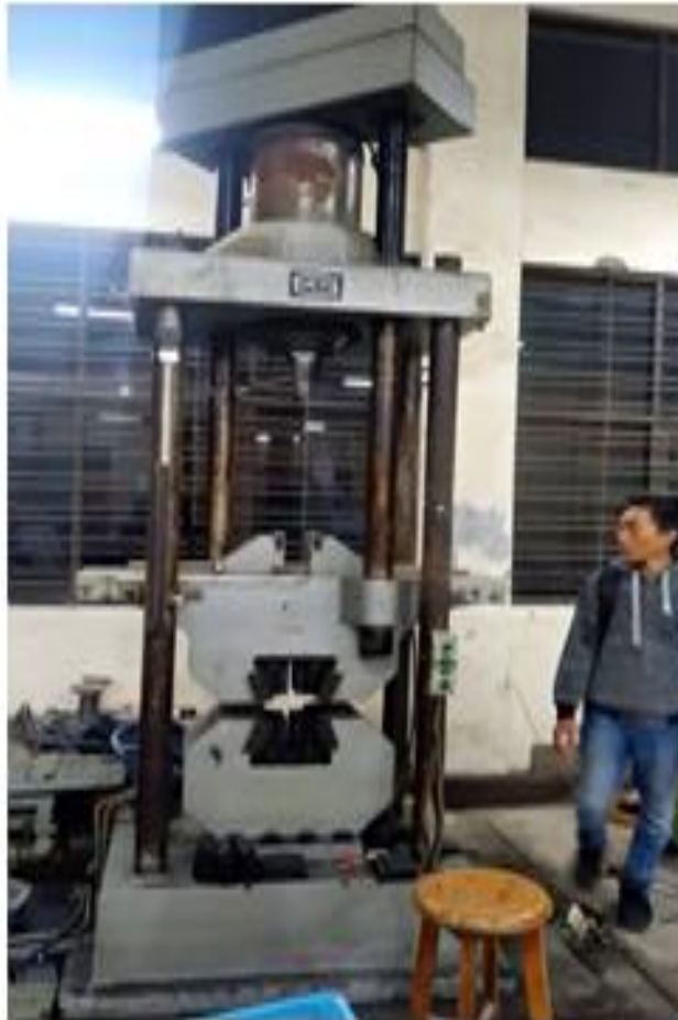
Mesin uji tarik di fakultas teknik sipil UB
