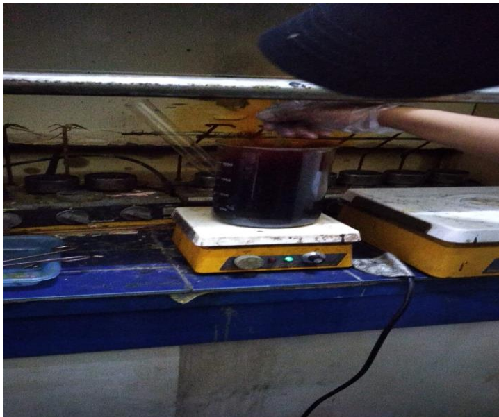
Pengadukan larutan \text{HNO}_3 dengan magnetic stirrer pada proses electroless plating
