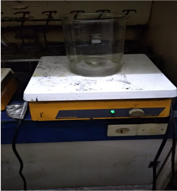
Pengadukan larutan \text{HNO}_3 dengan magnetic stirrer pada proses electroless plating
