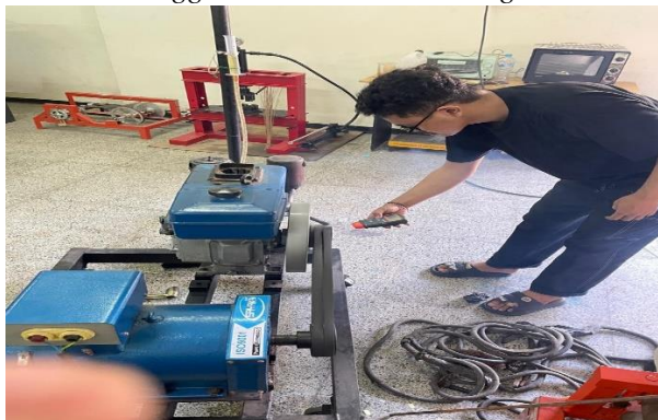
Gambar Proses mencari putaran Rpm Menggunakan Tachometer Digital
