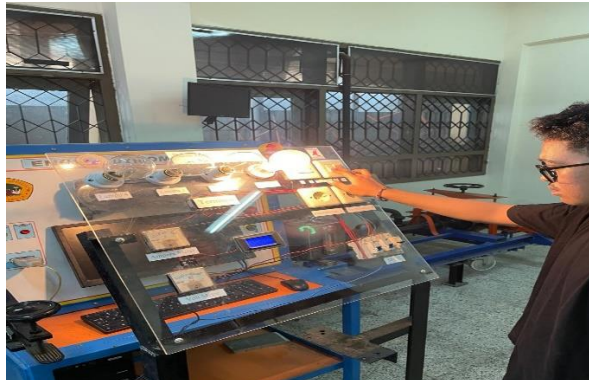
Gambar Proses menyalakan beban dan memerhatikan amperemeter dan voltmeter pada papan instrumen
