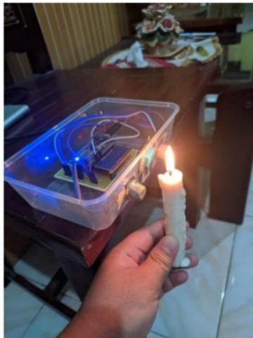
Gambar 3. 3 Pengujian Sensor DHT-11 Menggunakan Lilin
