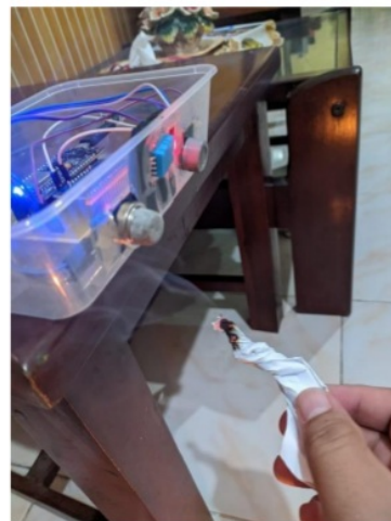
Gambar 3. 2 Pengujian Sensor MQ-135 Menggunakan Kertas Terbakar
