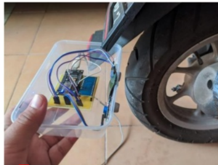
Gambar 3. 4 Pengujian Sensor MQ-7 Menggunakan Knalpot motor
