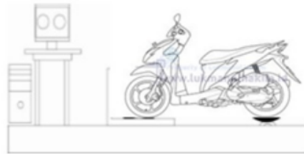
Gambar 2. Ilustrasi dynotest alat uji daya dan torsi
