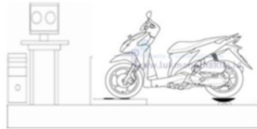
Gambar 2. Ilustrasi dynotest alat uji daya dan torsi
