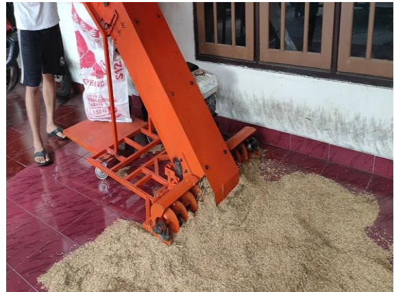
Proses Pengujian mesin pengemas gabah sederhana.
