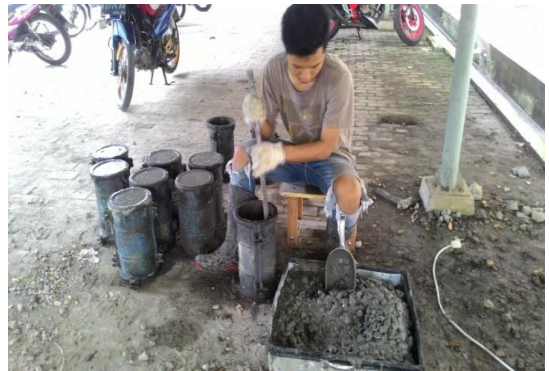
Gambar 5.16 Proses Pencetakan Benda Uji
