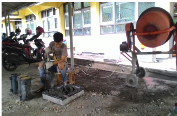
Gambar 5.16 Proses Pencetakan Benda Uji
