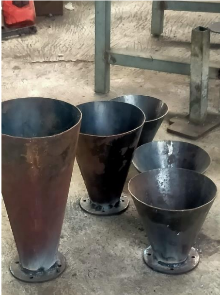
Fabrikasi Corong Output dengan 5 Variabel sudut
