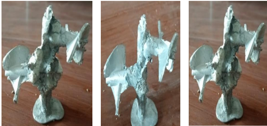
Hasil pengecoran cetakan gypsum 1,25:1, 2:1, 3:1
