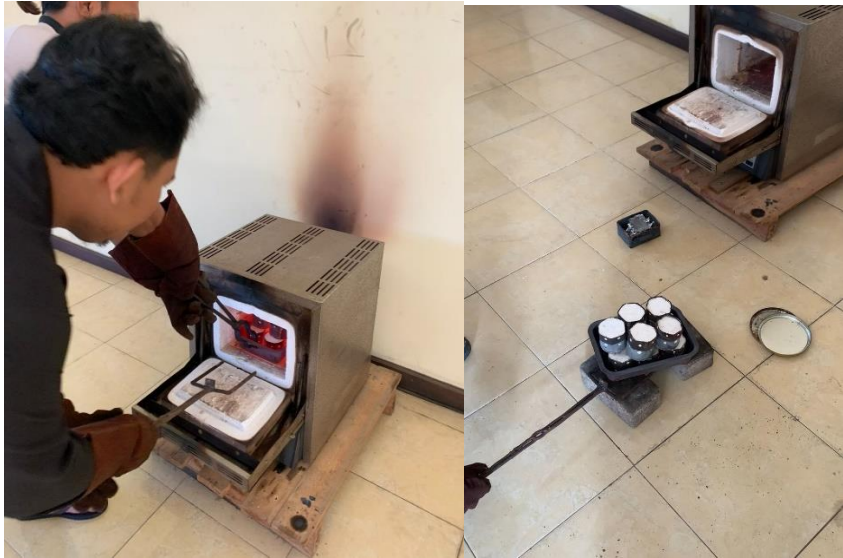
Proses pengambilan cetakan gypsum yang telah dicairkan
