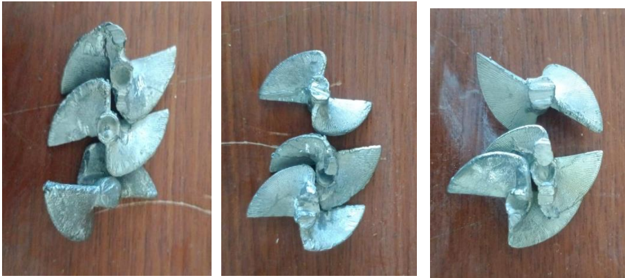
Hasil pengecoran cetakan gipsum 1,25:1, 2:1, 3:1
