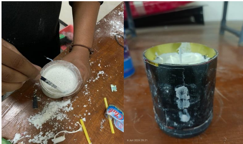
Proses pengadukan bubuk gypsum dan penuangan gypsum kedalam kaleng
