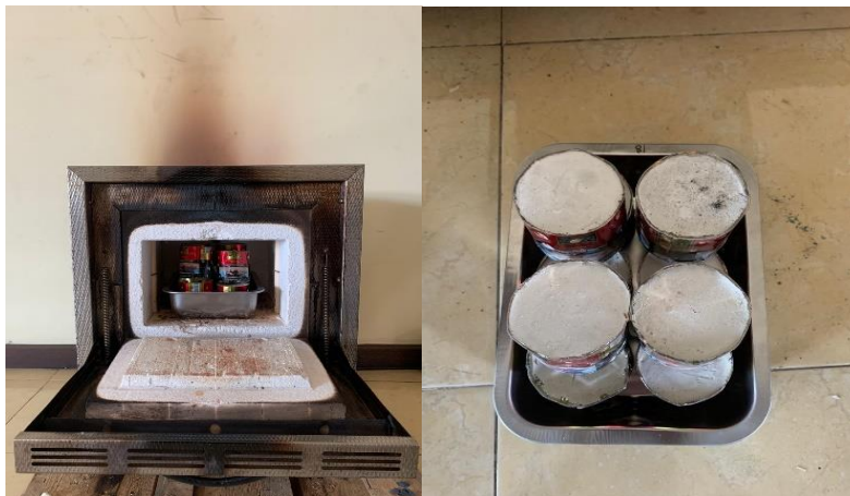
Proses pencairan PLA didalam furnace (alat pemanasan)
