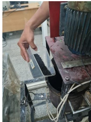
GAMBAR 3.17 Penuangan Pasir Vulkanik ke Tungku Pemanas
