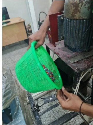
GAMBAR 3.16 Penuangan HDPE ke Tungku Pemanas
