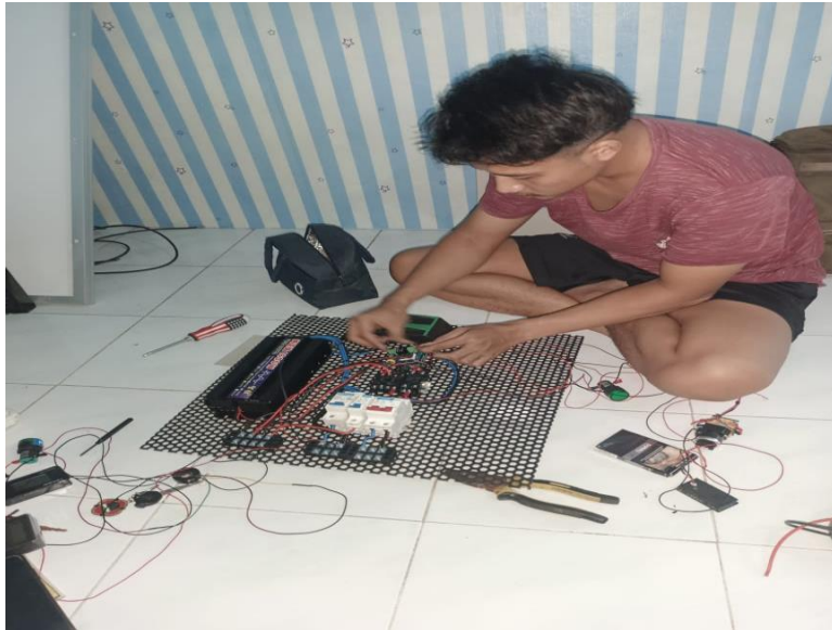
Lampiran Gambar 2 Pemasangan Inverter, SCC, dan ATS
