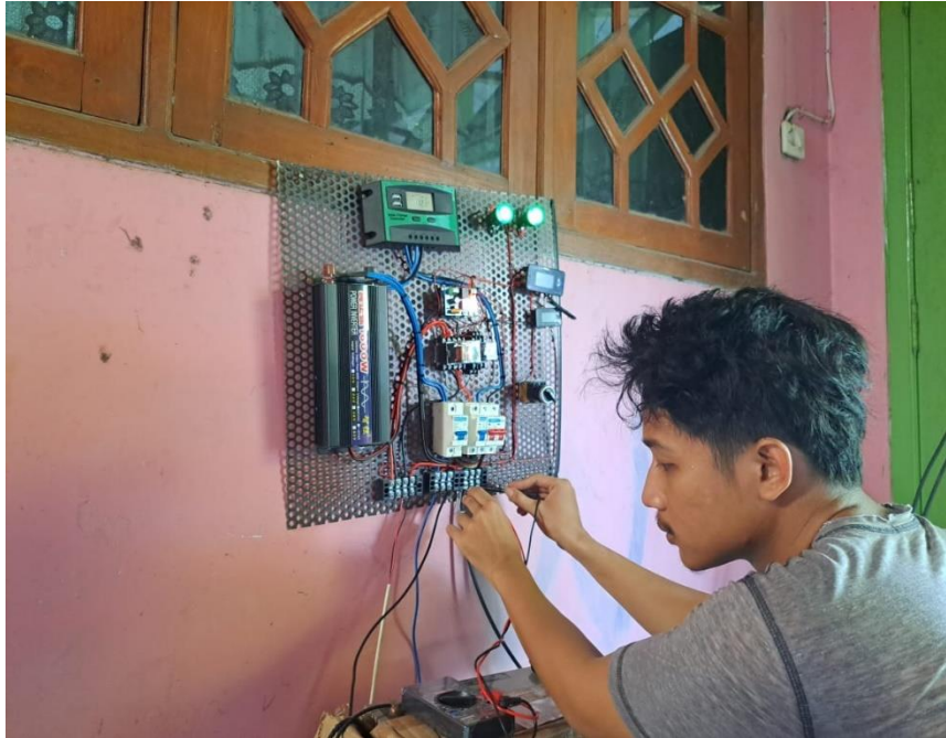
Lampiran Gambar 6 Pengukuran Tegangan dan Arus Panel Surya
