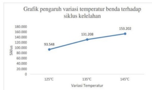
Gambar 4.21 Grafik pengaruh variasi temperatur benda kerja terhadap siklus kelelahan
