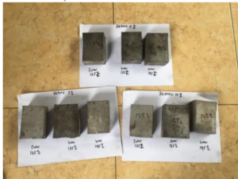
Gambar.1 bahan setelah dipressing Langkah selanjutnya adalah membentuk bahan tersebut menjadi spesimen uji untuk pengujian thermomechanical
