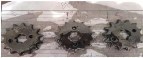
Gambar 2. . Spesimen pada saat proses hardening dengan temperatur 800°C (A), 850°C (B), 900°C (C)
