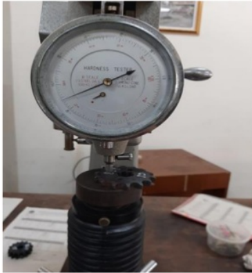
Gambar 8. Pengujian kekerasan Rockwell
