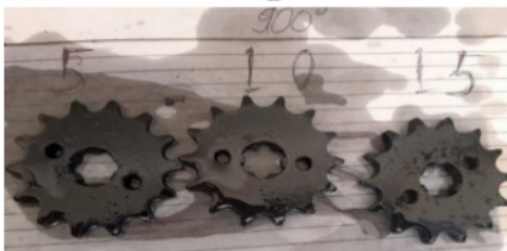
Gambar 3. Spesimen setelah proses hardening dengan temperatur 800°C sekaligus di quenching dengan media pendingin oli dan waktu penahan 5 menit, 10 menit, 15 menit (A), 850°C (B), 900°C (C)
