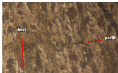
Gambar 10. Hasil pemotretan pembesaran 500x spesimen gear spraket tanpa perlakuan panas
