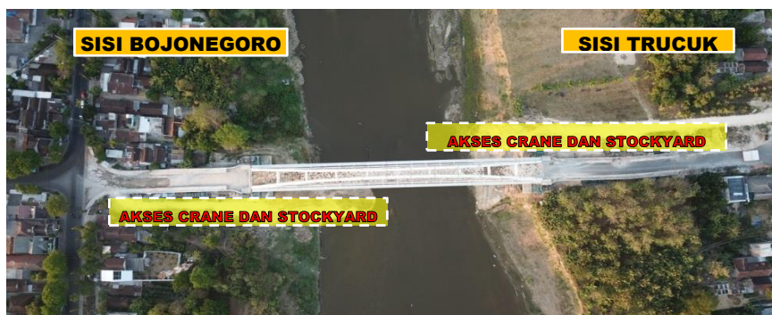
Gambar 4.6. Erection Plan menggunakan Crawler Crane 250 ton
