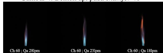
Gambar 5. Bentuk api pada chamfer 60°
