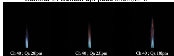
Gambar 4. Bentuk api pada chamfer 40°
