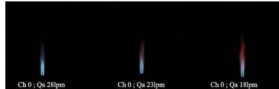
Gambar 3. Bentuk api pada chamfer 0°
