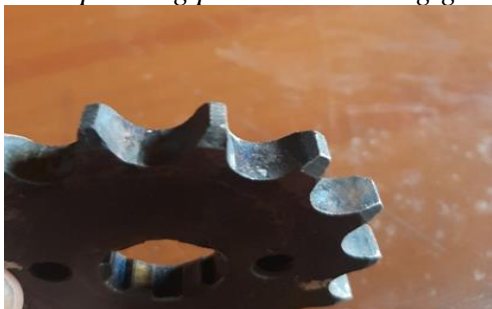
Gambar 3. Hasil mata gigi dengan tekanan 30 bar.
