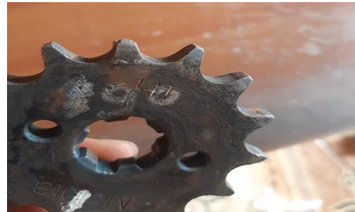
Gambar 5. Hasil mata gigi dengan tekanan 90 bar.
