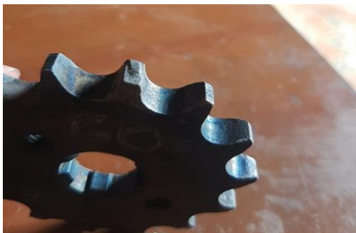
Gambar 3. Hasil mata gigi dengan tekanan 30 bar.
