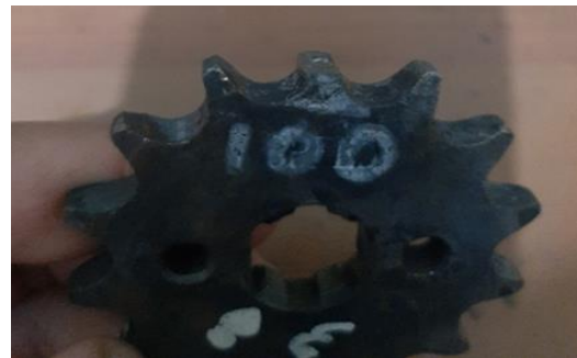
Gambar 6. Hasil mata gigi dengan tekanan 100 bar.
