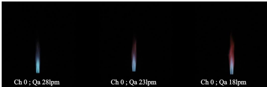
Gambar 4. 1 Foto api Inverse Diffusion Flame dengan tekanan bahan bakar 0,75 bar, chamfer 0°, tekanan udara 5,5 bar
