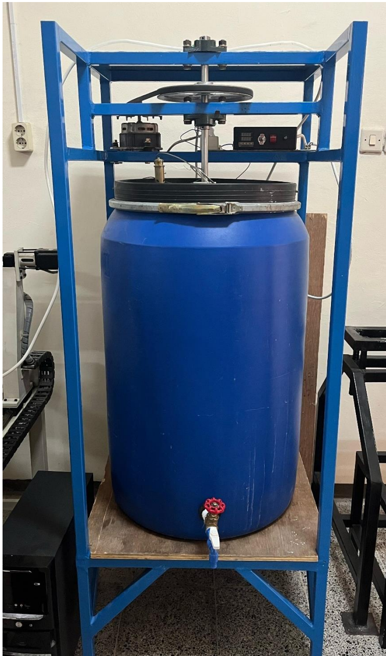
Lampiran 4. Gambar prototype alat bioreaktor anaerob oleh Nawang Sonia
