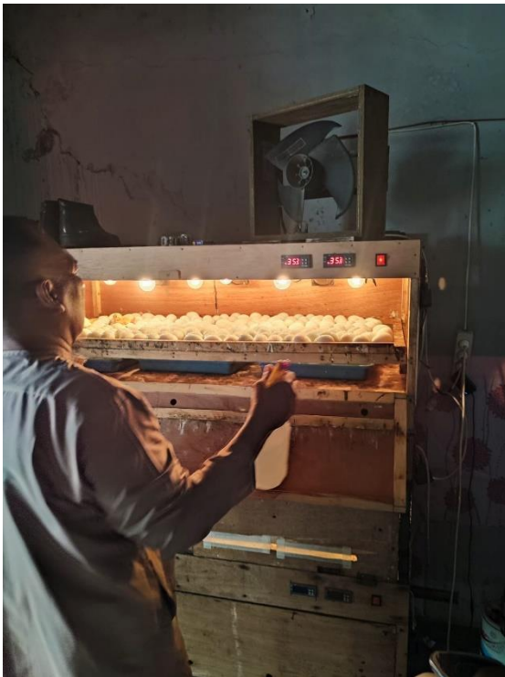
Gambar Pemilik Menyemprotkan Air Pada Telur Guna Mengatur Kelembapan Pada Mesin Penetas
