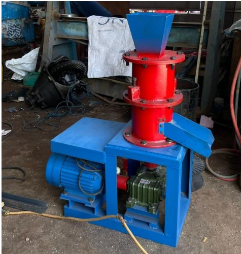
Lampiran 4 Rancangan Mesin Cetak Pelet Ayam
