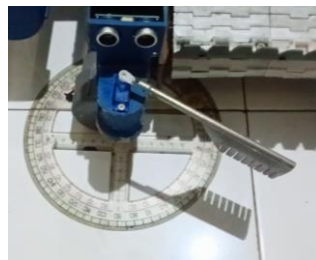
Gambar 4.7 Pengujian Motor Servo
