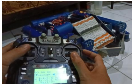
Gambar 4.5 Pengujian Kecepatan Perputaran Konveyor
