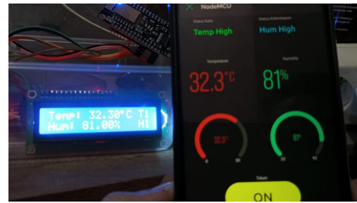
Gambar 11 Layar LCD dan Aplikasi Blynk saling terkoneksi
