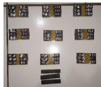
Gambar 1. Pembentukan spesimen untuk pengujian rockwell dan Impak
