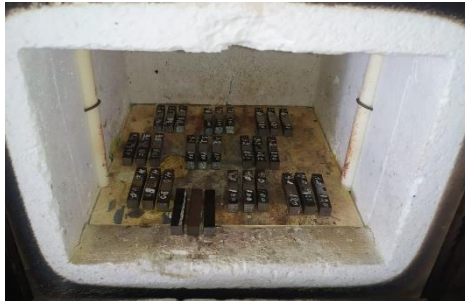
Gambar 2. Spesimen yang dikenai perlakuan panas
