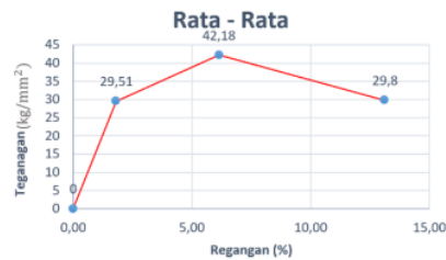
3 Gambar 15. Grafik Tegangan dan Regangan pada Variasi Pengelasan Arus 85A Media Pendingin Solar
