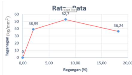
Gambar 8. Grafik Tegangan dan Regangan pada Spesimen Raw Material
