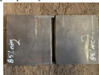
Gambar 3. Tack weld untuk material
