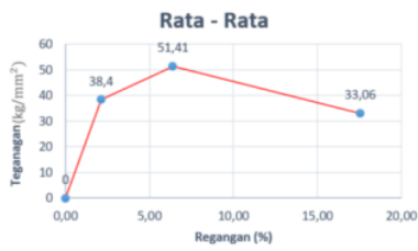
5 Gambar 10. Grafik Tegangan dan Regangan pada Variasi Pengelasan Arus 95A Media Pendingin Air
