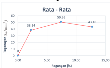
Gambar 12. Grafik Tegangan dan Regangan pada Variasi Pengelasan Arus 85A Media Pendingin Oli
