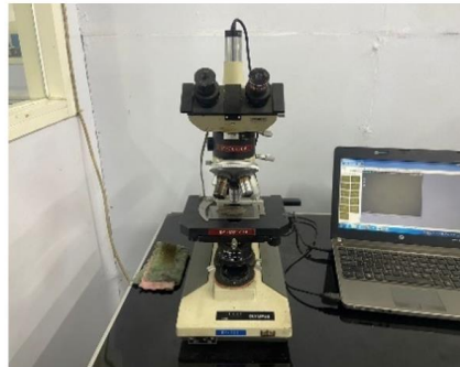
Gambar 7. Mikroskop Optik pada Uji Struktur Mikro
