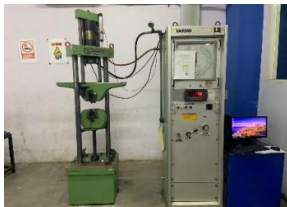
Gambar 6. Mesin pada Uji Tarik
