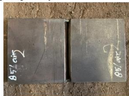
Gambar 3. Tack weld untuk material
