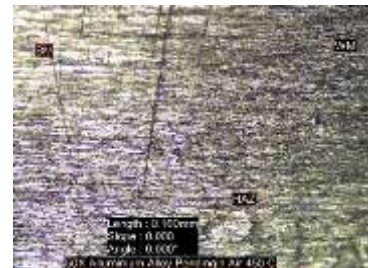
Gambar 7. Hasil mikro temperatur pemanasan 500 dengan media pendinginan air.
