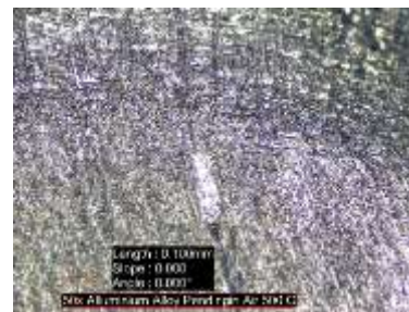
Gambar 6. Hasil mikro temperatur pemanasan 450 dengan media pendinginan air
