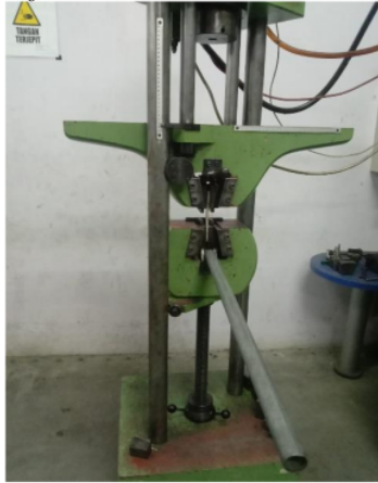
Gambar.proses pengujian tarik Mesin Uji Tarik disini adalah Alat Yang Bekerja dengan cara Menarik Benda kerja atau spesimen Uji Digunakan untuk mengetahui Kekuatan Tarik Seperti Ditabel.
