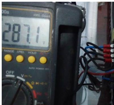
Gambar 4.3 Hasil Pengukuran Regulator Dari Sisi Output
