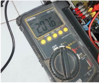
Gambar 4.2 Hasil Pengukuran Regulator Dari Sisi Input
