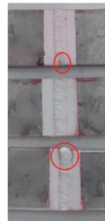
Gambar 14 hasil uji penetrasi elektroda diameter 1,2 dengan arus 110A
