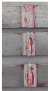
Gambar 7 hasil uji penetrasi elektroda diameter 0,8 dengan arus 100A
