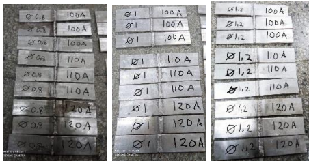
Gambar 3 Hasil Proses Las MIG
