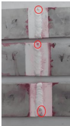
Gambar 11 hasil uji penetran elektroda diameter 1,0 dengan arus 110A
