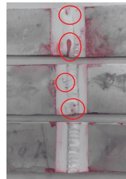
Gambar 13 hasil uji penetran elektroda diameter 1,2 dengan arus 100A
