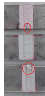
Gambar 14 hasil uji penetran elektroda diameter 1,2 dengan arus 110A
