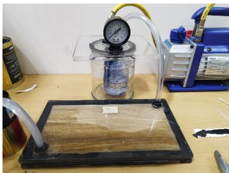
Gambar 14 Proses Pembuatan Komposit
