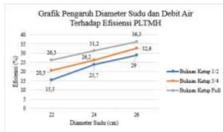
Gambar 11. Grafik Pengaruh Diameter Sudu dan Debit Air terhadap Efisiensi PLTMH
