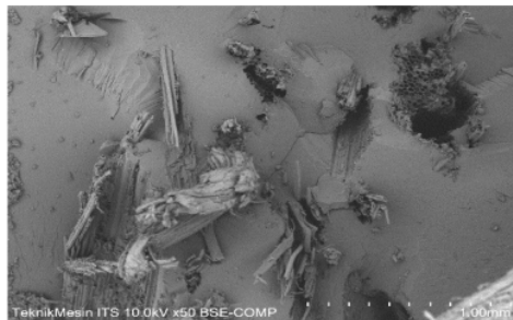
Gambar 13 Hasil Uji SEM Spesimen Tarik (C5.3) Perbesaran 50x
