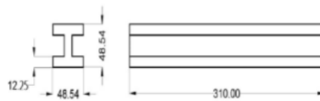
Gambar 3. Desain Bentuk Batang Pendulum Mesin Uji Impact Charpy
