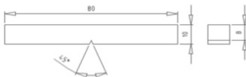
Gambar 17. Ukuran Spesimen Uji
