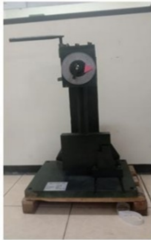
Gambar 16. Mesin Uji Impact Charpy Hasil Rancangan
