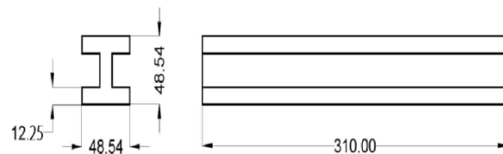
Gambar 3. Desain Bentuk Batang Pendulum Mesin Uji Impact Charpy
