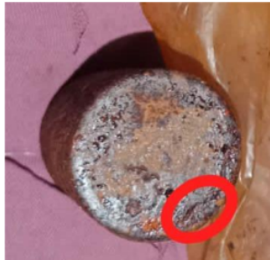
Gambar 5. Korosi Celah (Sodium Nitrit 15 Hari)
