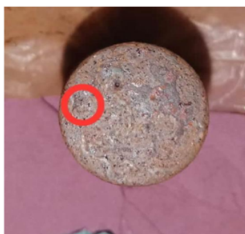
Gambar 4. Korosi Sumuran (Asam Fosfat 5 Hari)
