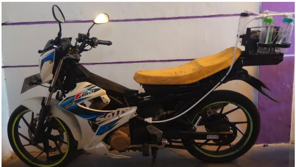
Generator Hydrogen Setelah Terpasang
