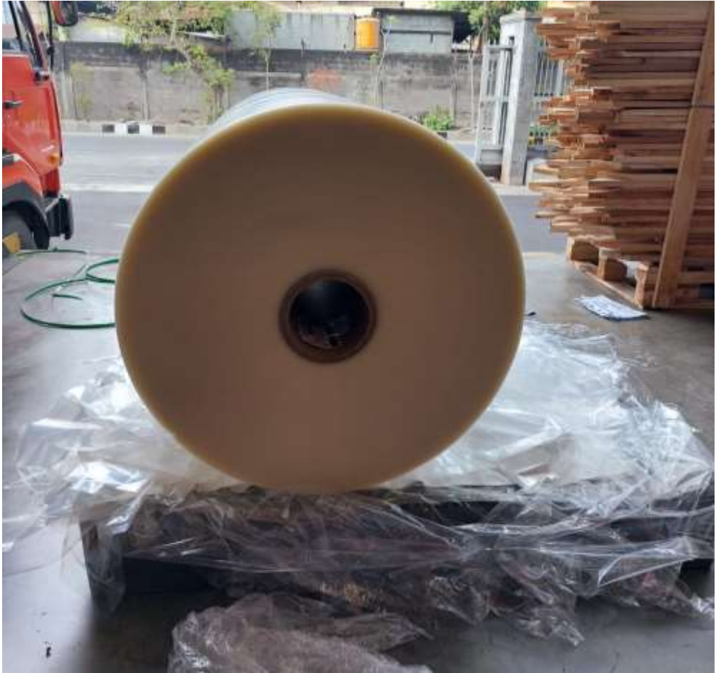
Gambar Lampiran 4. Contoh Material Printing Layer OPP Sumber: (Data Perusahaan)
