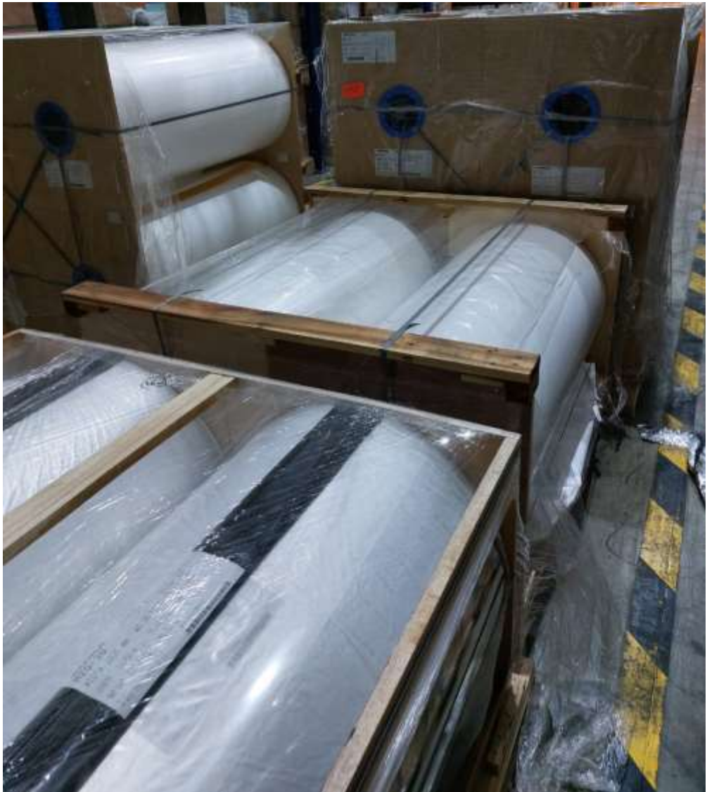
Gambar Lampiran 7. Contoh Material Printing Layer PET, OPP Sumber: (Data Perusahaan)
