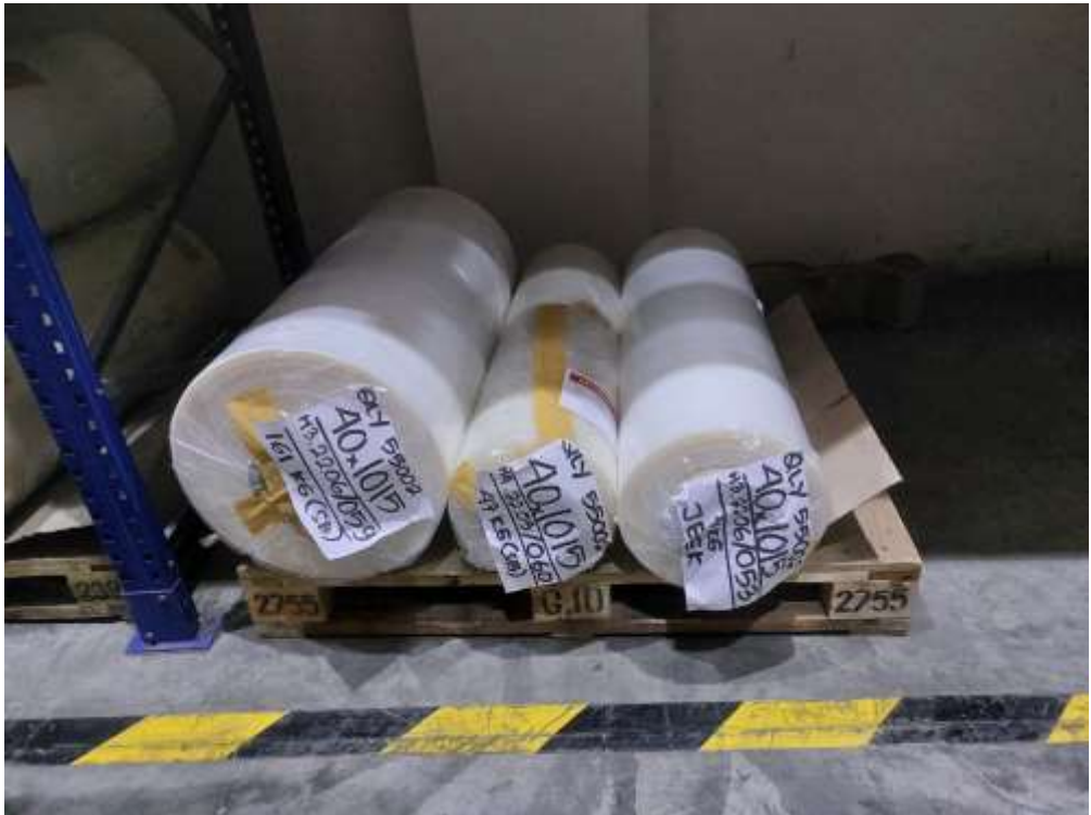
Gambar Lampiran 8. Contoh Material Seal Layer LDPE, CPP dan PP . Sumber: (Data Perusahaan)
