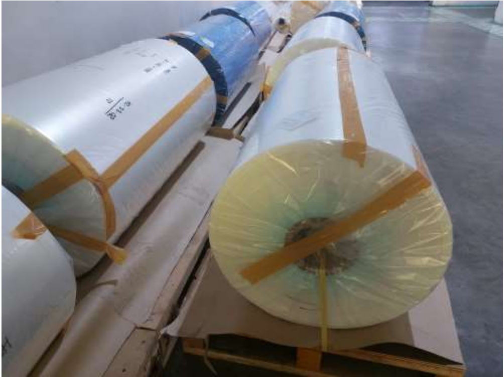
Gambar Lampiran 9. Contoh Material Seal Layer adalah LDPE, CPP . Sumber: (Data Perusahaan)
