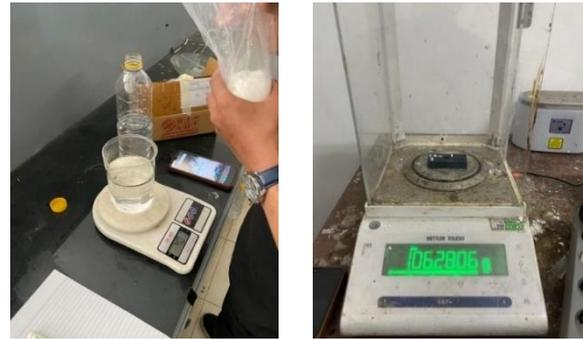
Gambar 3.25 Alat Pengukuran Berat Material dan Proses Pelarutan NaCl 10%
