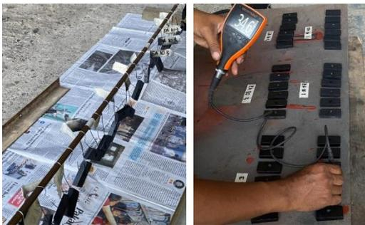
Gambar 3.24 Pengukuran Ketebalan Cat Kering
