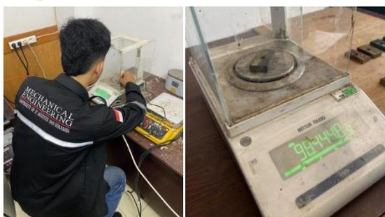
Gambar 3.29 Penimbangan Akhir Spesimen
