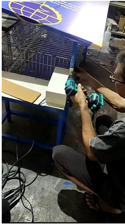
Lampiran 1. 4 Pemasangan rumah mesin
