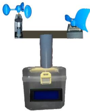
Gambar 10 Mekanik Alat Pendeteksi Kecepatan Dan Arah Angin
