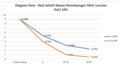
Gambar 4.4 Diagram rata-rata selisih massa penimbangan akhir dengan Larutan NaCl 10 %
