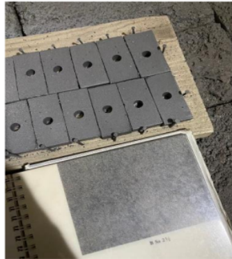
Gambar 3.18 Verifikasi Hasil Blasting
