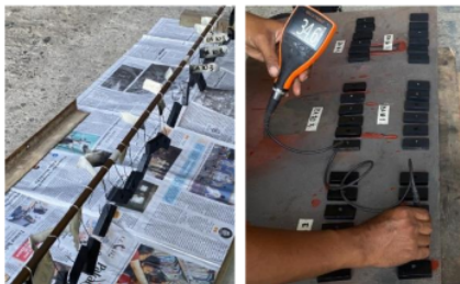
Gambar 3.24 Pengukuran Ketebalan Cat Kering
