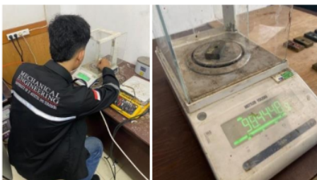
Gambar 3.29 Penimbangan Akhir Spesimen
