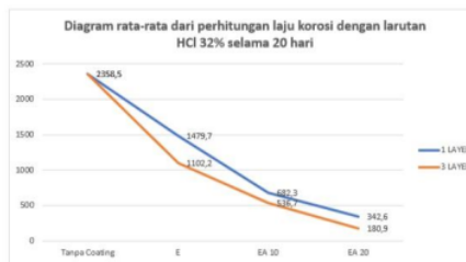
Gambar 4.5 Diagram rata-rata dari perhitungan laju korosi dengan larutan HCl 32% selama 20 hari
