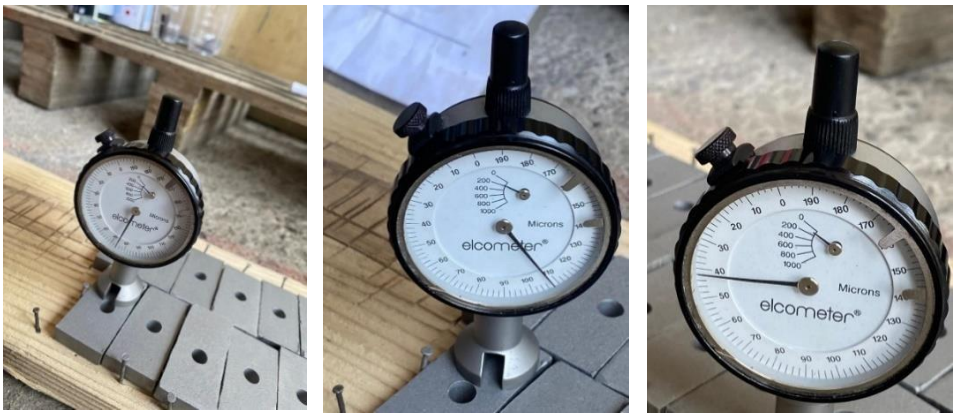
Verifikasi Kekasaran Permukaan menggunakan elcometer surface profile gauge
