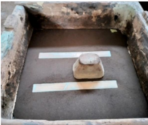
Gambar 4. Inti Pada Proses Pengecoran
