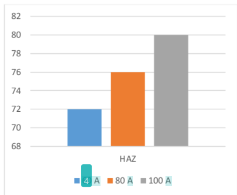
Gambar Grafik nilai rata-rata weld metal HAZ uji rockwell kampuh V
