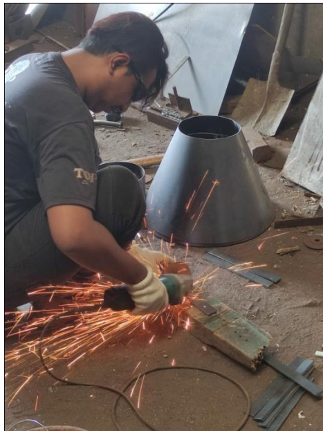
Lampiran 2 proses pemotongan spesimen sebelum di las
