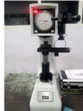
Gambar 3.4 Alat Uji Kekerasan Brinell Car son Model MOPA O3
