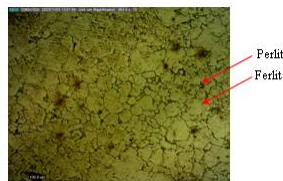
Gambar 4. 11 Struktur Mikro ST 60 Pendinginan Media Udara
