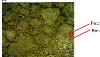
Gambar 4. 8 Struktur Mikro ST 42 Pendinginan Media Udara
