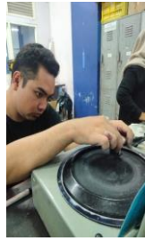
Gambar 3. 15 Pegolesan menggunakan Autosol
