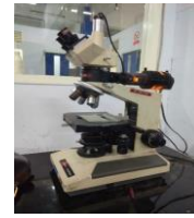
Gambar 3. 12 Mikroskop Olympus B2
